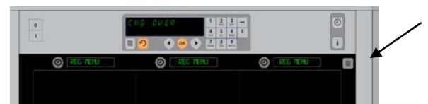
L'enclenchement du bouton de menu de la ligne (voir flèche) produit une séquence de choix de menus.
